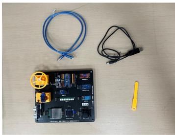
磁鐵NKNUBLOCK 5016B (若同時多個感測元件啟動，或伺服馬達、減速馬達同時啟動)建議插上5V電線
